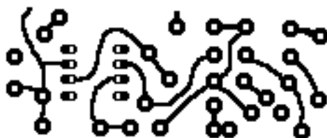
Obrázek 4.2: Metoda spojovacích cest – spoje „od ruky“
