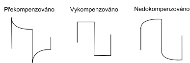
Obrázek 3.11: Průběhy na překompenzované, vykompenzované a nedokompenzované sondě
