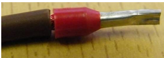
obr. 102 – Špatně nalisovaná dutinka s izolací – je vidět lanko
