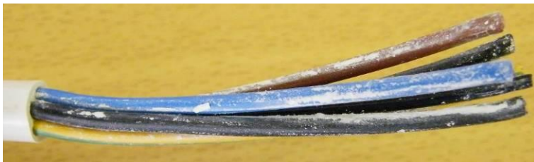
obr. 142 – izolace po přetržení
