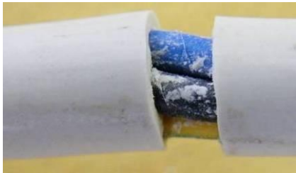
obr. 142 – izolace po přetržení
