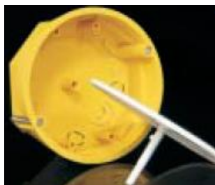
obr. 171 – krabice odbočná KO 97/L – krabice KO 97 + víčko KO 97/1, vnější průměr 103 mm, vnitřní průměr 97 mm, hloubka 50 mm
