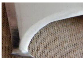
obr. 150 – nový zařezávací nůž, dole je kolečko na nastavení hloubky zaříznutí
