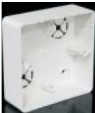
obr. 179 – krabice přístrojová vysoká LK 80X28 R/1, vnější rozměr 81 x 81 x 28 mm, používaná pod přepínače a jednoduché zásuvky
