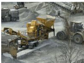
obr. 522 – ukázka mobilní recyklační linky
