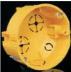
obr. 168 – krabice univerzální KU 6871/L1, vnější průměr 73 mm hloubka 45 mm, lze sestavit do řady se středovou roztečí 71 mm. Výrobce doporučuje maximálně 3 krabice v řadě.
