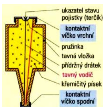
obr. 243 – jistič do pojistkového spodku
