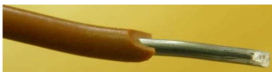
obr. 94 – dobře odizolovaný hliníkový vodič
