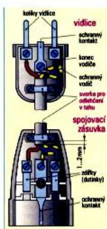
obr. 396 – zapojení prodlužovací šňůry
