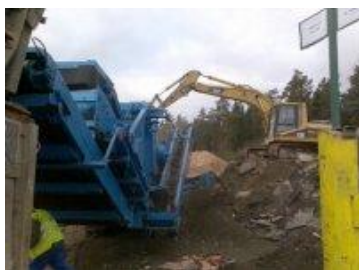
obr. 522 – ukázka mobilní recyklační linky
