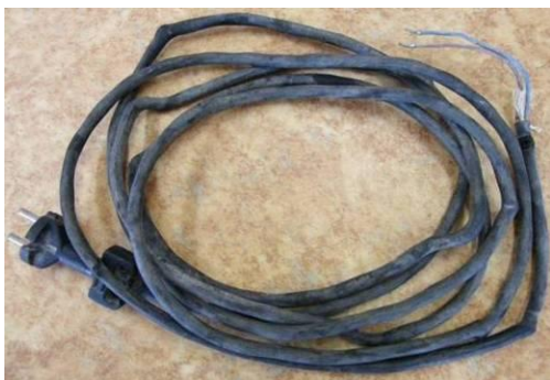
obr. 154 – ukázka poškozené šňůry překlesáním a nevhodným uložením, vymontovaná z bouracího kladiva
