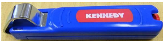
obr. 150 – nový zařezávací nůž, dole je kolečko na nastavení hloubky zaříznutí
