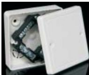
obr. 178 – krabice rozvodná nízká LK 80 R/2 s víčkem VLK 80/R a svorkovnicí S-66, vnější rozměr 81 x 81 x 24,5 mm
