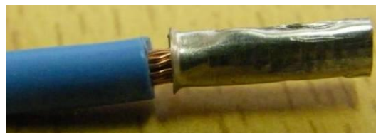
obr. 103 – špatně nalisovaná dutinka bez izolace – je vidět lanko
