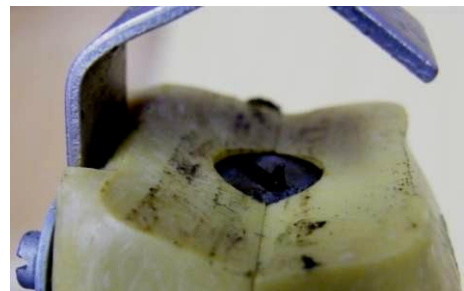
obr. 149 – uprostřed je vidět hrot břítu, který prořezává izolaci
