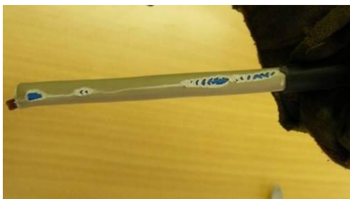
obr. 138 – odříznutí pláště kabelu
