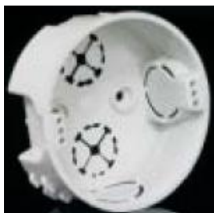
obr. 156 – krabice přístrojová KP 68/2, vnitřní průměr 68 mm, vnější průměr 73 mm, hloubka krabice 30 mm. Materiál je samozhášivý. Rozsah použití -5^{\circ}\text{ C} - +60^{\circ}\text{ C}
