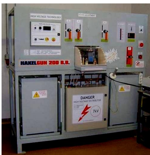
obr. 463 – HAKELGUN 200BB Generátor impulsů bleskového proudu s provozní kapacitou do I_{\text{imp}} = 210 \text{ kA (10/350)} .
