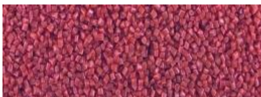
obr. 118 – ukázka regranulátu a aglomerátu
