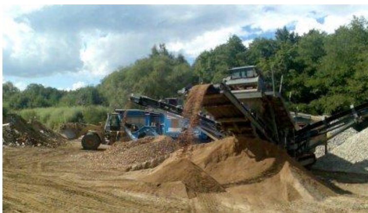
obr. 521 – ukládání jednotlivých velikostí na mobilní recyklační lince
