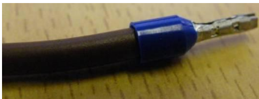
obr. 101 – dobře nalisovaná dutinka s izolací
