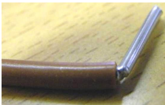
obr. 96 – nalomený vodič v zářezu vodiče při prvním ohybu
