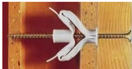
obr. 231 – řez zdivem s hmoždinkou
