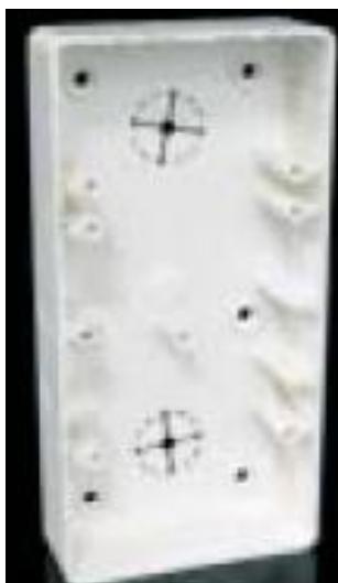
obr. 181 – krabice přístrojová vysoká dvojitá LK 80X28 2ZK, vnější rozměr 160 x 81 x 28 mm, používaná pro montáž dvou přístrojů, nebo u podlahy pro montáž jednoho přístroje a svorkovnice s víčkem
