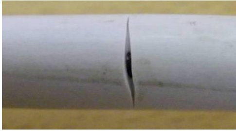
obr. 140 – naříznutí izolace šňůry
