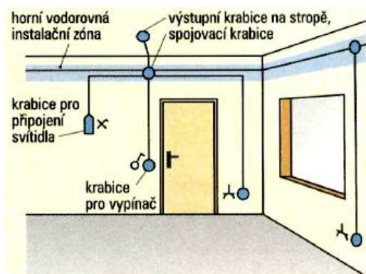
obr. 277 – ukládání elektrických vedení do instalačních zón s rozvodnými krabicemi
