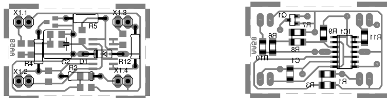
Obr. 2 – Výkres osazení, strana součástek, strana strana spojů
