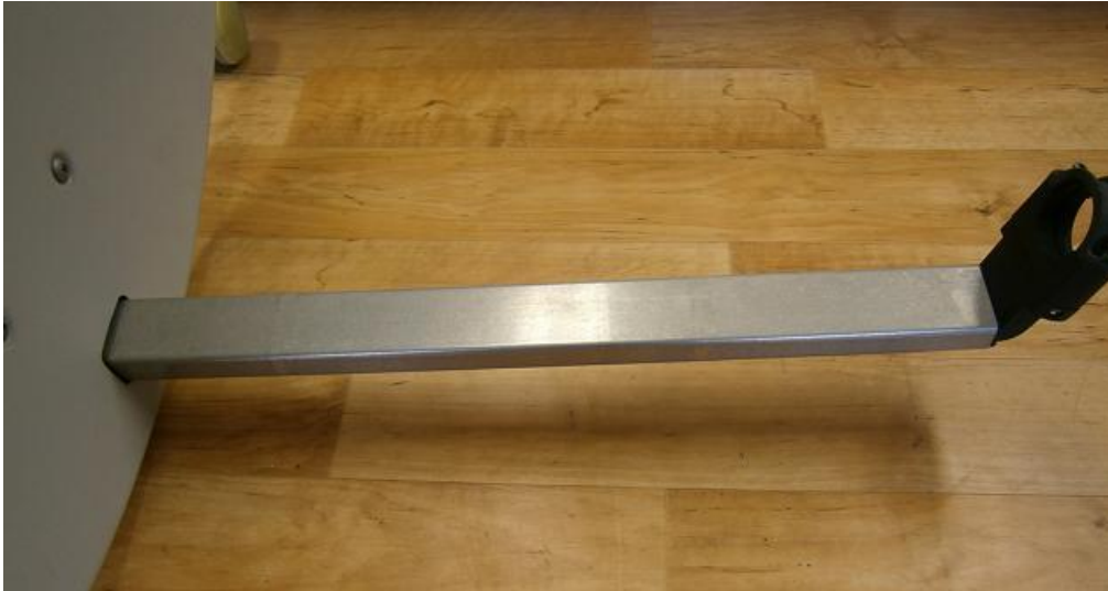
Zkompletované rameno s držákem konvertoru
