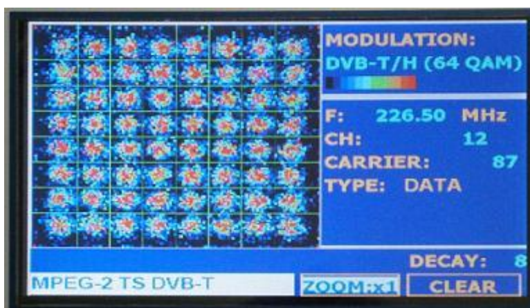
Konstelační diagram modulace 64-QAM nosné číslo 87 (datová nosná)
